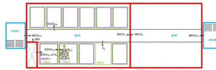
Abbeelding 2.3: vertaling van brandwerendheids-rookdoorlatendheidsplan op 'typische' plattegrond (logies)
